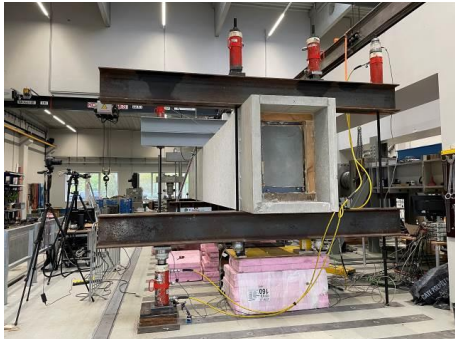
Abb. 14: Frontansicht auf den Versuchsaufbau. Die Pressen links und rechts dienen zur Aufbringung des Torsionsmoments. Die roten Pressen über den grauen Trägern im Hintergrund dienen zur Vorspannung gegen das Aufspannfeld.
