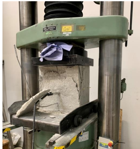
Abb. 22: Zerstörender Versuch der Vorversuche in der Druckpresse
