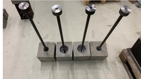
Abb. 4: Fertige Versuchskörper: UHPC Zylindereinbetoniert in Betonwürfel
