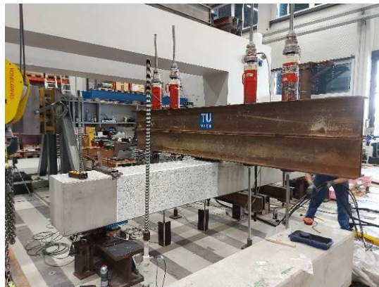
Abb. 24: Versuchsaufbau der Querkraftversuche (Feldversuch ohne Bauteilfuge)
