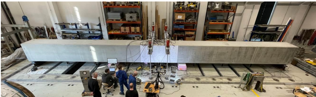
Abb. 2: Brückenträger aus dünnwandigen Fertigteilen während eines Belastungsversuchs
