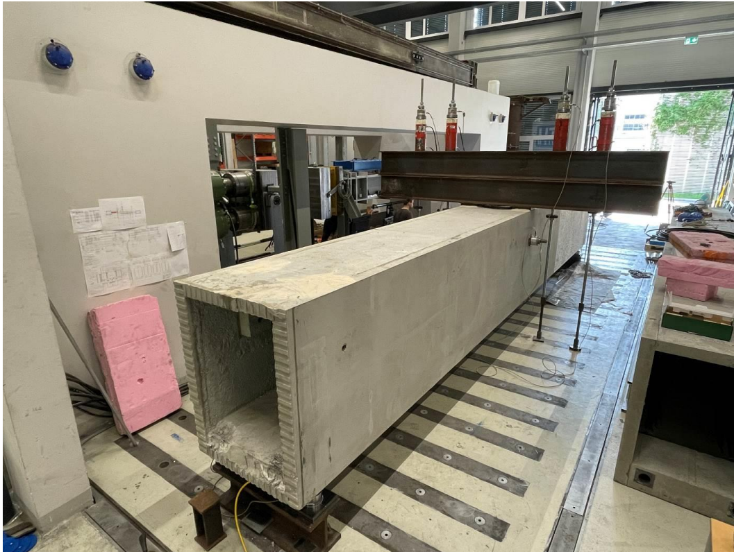
Abb. 13: Versuchsaufbau der durchgeführten Querkraftuntersuchungen
