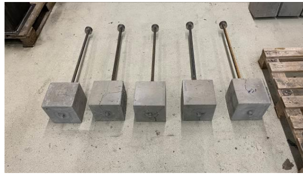
Abb. 6: Zerstörte Versuchskörper: Spaltzugversagen und Fließen im Stahl
